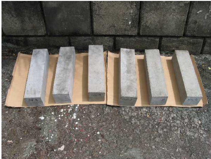
供試体吹付前
