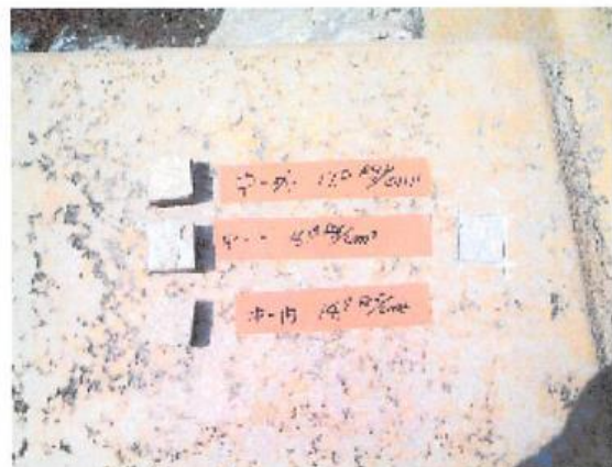
写真-3. 破断状況 試験後の接着面の破断状況は界面破断ではなく、写真に示すようにアタッチメントに基盤コンクリートが付着した状態の、いわゆる下地破断であった。このことは実際の付着強度は測定値以上のものがあったことを示すものである。 写真は護岸パレット中央部の測定データを示したもので、上から順に堤外側、天端部、堤内側の破断面とその強度を示す。
