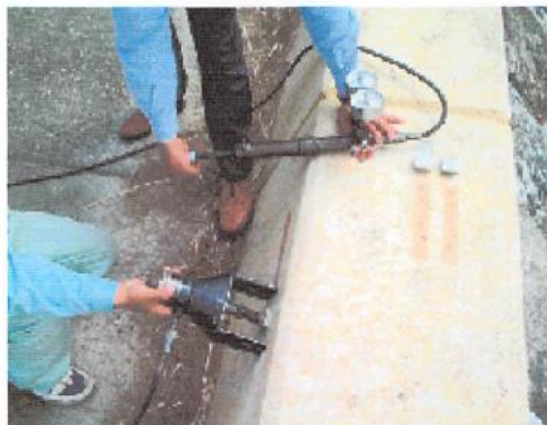
写真-2. 測定状況（建研式引張り試験機による） ハンドルを回すと、塗装面に取り付けられたアタッチメント（40×40mm）が油圧によって引き抜かれ、加えられた力が測定される。
